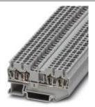
Durchgangsklemme, Anschlussart: Zugfederanschluss, Querschnitt: 0,08 mm² - 4 mm², AWG: 28 - 12, Breite: 5,2 mm, Farbe: grau, Montageart: NS 35/7,5, NS 35/15
