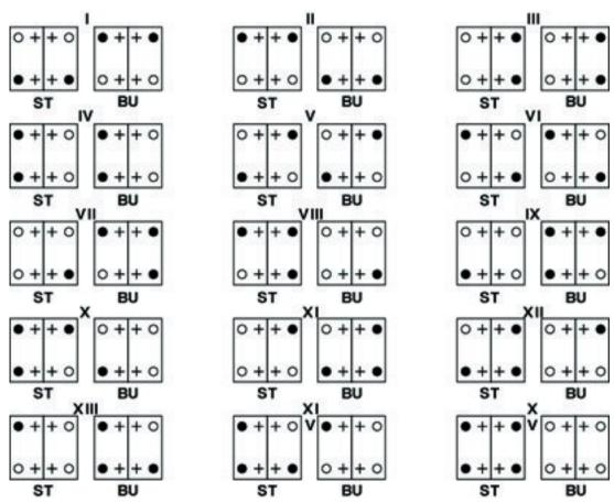
Kodierung für Gehäuse mit zwei Kontakteinsätzen
