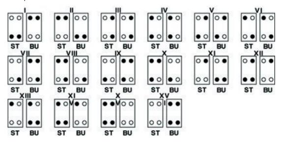
Kodierung für Gehäuse mit einem Kontakteinsatz
