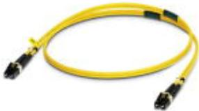
Konfektioniertes LWL-Kabel, Break-Out-Kabel, Glasfaser Singlemode 9/125 µm, Stecker: LC / LC, Schutzart: IP20, für die Verlegung in Kabelkanälen oder Schaltschränken, Länge: 1 m
