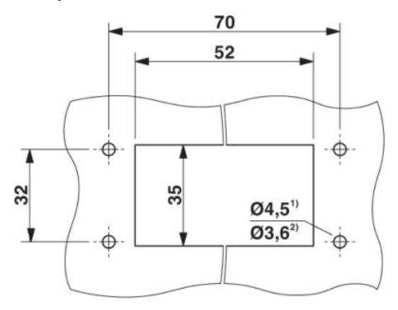
$Montageausschnitt^{1)} bei\ Einsatz\ von\ M4-Schrauben^{2)} bei\ Einsatz\ von\ selbstfurchenden\ Schrauben\ (Torx @20,\ M4)$
