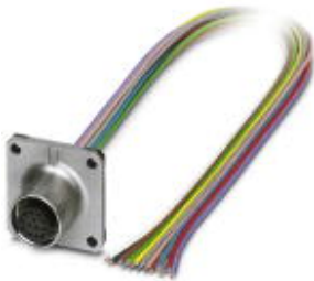
Sensor-/Aktor-Einbaubuchse, 12-polig, M12, A-kodiert, Vorderwand-/Vierkantflanschmontage, mit 0,5 m TPE-Litze, 12 x 0,14 mm
