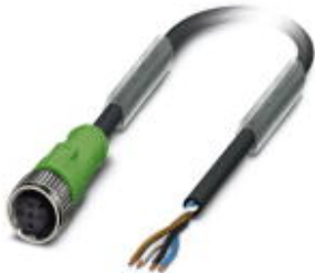
Sensor-/Aktor-Kabel, 4-polig, PUR halogenfrei, schwarzgrau RAL 7021, freies Leitungsende, auf Buchse gerade M12, A-kodiert, Kabellänge: 15 m
