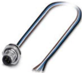
Sensor-/Aktor-Einbaustecker, 4-polig, M12-SPEEDCON, Hinterwand-/Schraubmontage mit M16 Gewinde, mit 0,5 m TPE-Litze, 4 x 0,34 mm 2
