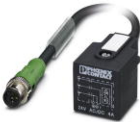
Sensor-/Aktor-Kabel, 3-polig, PUR halogenfrei, schwarzgrau RAL 7021, Stecker gerade M12, A-kodiert, auf Ventilstecker A, mit 1 LED, beschaltet mit Z-Diode, Kabellänge: 1,5 m
