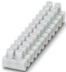
Europaklemmleiste aus Polypropylen, weiß, zum Verbinden von starren Leitern und flexiblen Leitern mit und ohne Aderendhülse mit einem Querschnitt von 0,5 bis 4 mm<sup>2</sup>
