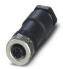
Steckverbinder, Universal, 4-polig, Buchse gerade M12, S-kodiert, Schraubanschluss, Rändelmaterial: Zinkdruckguss, vernickelt, Kabelverschraubung Pg11, Kabelaußendurchmesser 8 mm ... 10 mm
