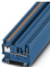
Durchgangsklemme, Anschlussart: Push-in / Steckanschluss, Querschnitt: 0,14 mm 2 - 4 mm 2 , AWG: 26 - 12, Breite: 5,2 mm, Höhe: 35,3 mm, Farbe: blau, Montageart: NS 35/7,5, NS 35/15
