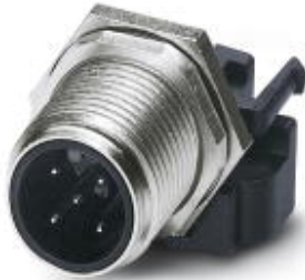
Sensor-/Aktor-Einbaustecker, 5-polig, M12, A-kodiert, Hinterwand-/Schraubmontage mit M12 Gewinde, verdrehgeschützt, mit geradem Lötanschluss
