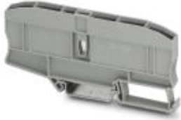
Endhalter, Breite: 8,2 mm, Farbe: grau, Montageart: NS 35/7,5, NS 35/15
