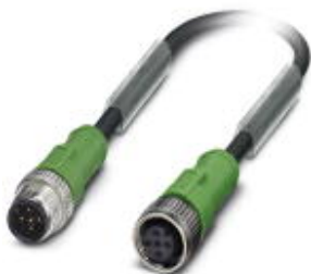
Sensor-/Aktor-Kabel, 5-polig, PUR halogenfrei, schwarzgrau RAL 7021, Stecker gerade M12, A-kodiert, auf Buchse gerade M12, A-kodiert, Kabellänge: 5 m
