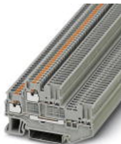
Doppelstock-Klemme, Querschnitt: 0,14 mm 2 - 1,5 mm 2 , AWG: 26 - 16, Anschlussart: Push-in- / Steckanschluss, Breite: 3,5 mm, Farbe: grau, Montageart: NS 35/7,5, NS 35/15
