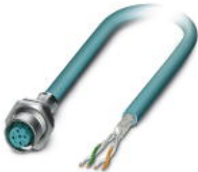
Bus-System-Einbaubuchse, ETHERNET, 4-polig, M12, geschirmt, D-kodiert, Hinterwand-/Schraubmontage mit M16-Gewinde, mit 0,5 m Buskabel, 2 x 2 x 0,14 mm 2
