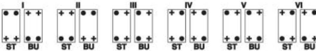
Kodierung für Gehäuse mit einem Kontakteinsatz
