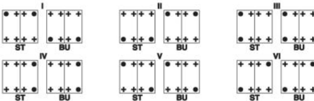
Kodierung für Gehäuse mit zwei Kontakteinsätzen
