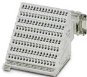
HEAVYCON Klemmenadapter Buchseneinsatz, Serie D64, 64-polig, PE-Anschluss links für die rechte Schaltschrankseite, Push-in-Anschluss
