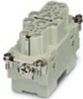
HEAVYCON-Buchseinsatz, Serie K6/12, mit 6 Leistungs- (Axialschraubanschluss) und 12 Steuerkontakten (Schraubanschluss)
