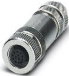
Steckverbinder, Universal, 12-polig, geschirmt, Buchse gerade M12, A-kodiert, Lötanschluss, Rändelmaterial: Zinkdruckguss, vernickelt, Kabelverschraubung Pg9, Kabelaußendurchmesser 6 mm ... 8 mm
