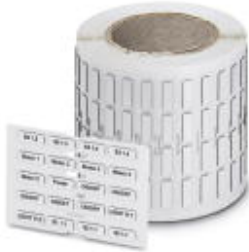
Kunststoffschild, Rolle, weiß, unbeschriftet, beschriftbar mit: THERMOMARK ROLL, THERMOMARK X, THERMOMARK S1.1, Montageart: Kleben, Schriftfeldgröße: 17 x 7 mm
