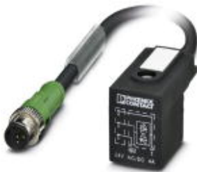
Sensor-/Aktor-Kabel, 3-polig, Stecker gerade M12, A-kodiert, auf Ventilstecker BI (11 mm), mit 1 LED, beschaltet mit Z-Diode
