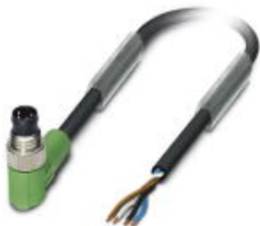
Sensor-/Aktor-Kabel, 4-polig, PUR halogenfrei, schwarzgrau RAL 7021, Stecker gewinkelt M8, auf freies Leitungsende, Kabellänge: 1,5 m
