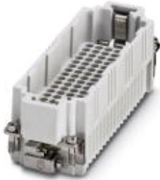
HEAVYCON Stifteinsatz, Serie DD108, 108-polig, Crimpanschluss. PE-Anschluss mittels Zughülstechnik.
