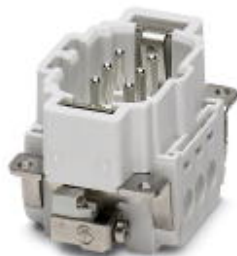
HEAVYCON Stifteinsatz, Serie B6, 6-polig, Schraubanschluss. PE-Anschluss mittels Zughülstechnik.
