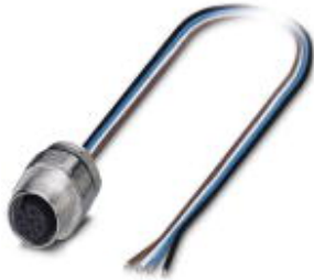
Sensor-/Aktor-Einbaubuchse, 4-polig, M12, A-kodiert, Vorderwand-/Schraubmontage mit Pg9-Gewinde, positionierbar, mit 0,5 m TPE-Litze, 4x 0,34 mm 2
