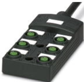
Sensor-/Aktor-Box, Anschlussart: M12-SPEEDCON-Buchse Kunststoff, Anzahl der Steckplätze: 6, Polzahl: 4, Steckplatzbelegung: einfach, Statusanzeige: Ja, pnp; Stammeleitungsanschluss: Festanschluss 180°, PUR/PVC, Leitungslänge: 10 m, Schirmung: nein
