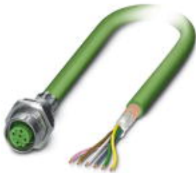
Bus-System-Einbaubuchse, INTERBUS, 5-polig, M12, geschirmt, B-kodiert, Hinterwand-/Schraubmontage mit M16-Gewinde, mit 2 m Buskabel, 3 x 2 x 0,25 mm 2
