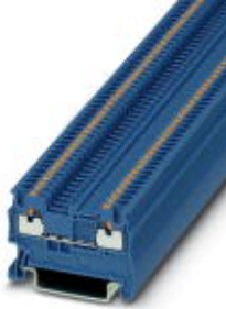
Durchgangsklemme, Anschlussart: Push-in-Anschluss, Querschnitt: 0,14 mm 2 - 1,5 mm 2 , AWG: 26 - 14, Breite: 3,5 mm, Höhe: 30,5 mm, Farbe: blau, Montageart: NS 35/7,5, NS 35/15
