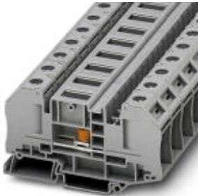
Trennklemme mit Bolzenanschlusstechnik, Querschnitt: 0,1 - 6 mm 2 , AWG: 26 - 10, Breite 16,3 mm, Farbe: grau
