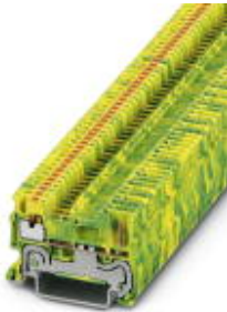
Schutzleiter-Reihenklemme, Anschlussart: Push-in- / Steckanschluss, Querschnitt: 0,14 mm 2 - 1,5 mm 2 , AWG: 26 - 16, Breite: 3,5 mm, Farbe: grün-gelb, Montageart: NS 35/7,5, NS 35/15
