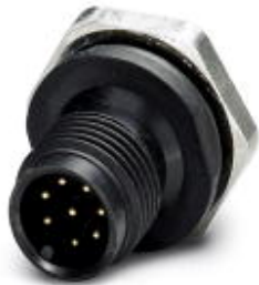
Sensor-/Aktor-Einbausteckverbinder, Stecker, 8-polig, M12, A-kodiert, Vorderwand-/Schraubmontage mit M16 Gewinde, mit Lötkelchen, Kunststoffausführung
