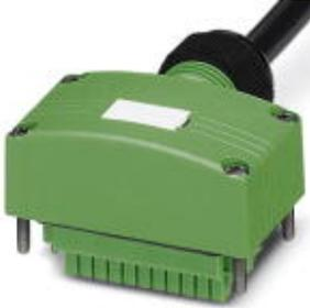
Anschlusshaube, verwendbar für Sensor-/Aktor-Box, Anschlussart: M12-SPEEDCON-Buchse Metall, Anzahl der Steckplätze: 8, Steckplatzbelegung: einfach, Statusanzeige: Nein; Stammleitungsanschluss: Steckbarer Schraubanschluss 180°, PUR/PVC, Leitungslänge: 10 m, Schirmung: nein
