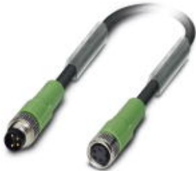
Sensor-/Aktor-Kabel, 4-polig, PUR halogenfrei, schwarzgrau RAL 7021, Stecker gerade M8, auf Buchse gerade M8, Kabellänge: 3 m
