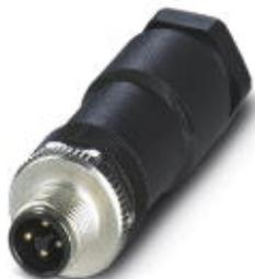
Steckverbinder, 4-polig, Stecker gerade M12, T-kodiert, Schraubanschluss, Rändelmaterial: Zinkdruckguss, vernickelt, Kabelverschraubung Pg11, Kabelaußendurchmesser 8 mm ... 10 mm
