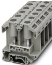
Universalklemme mit Bolzen-Anschluss, Querschnitt: 1 - 25 mm 2 , Breite: 18 mm, Farbe: grau
