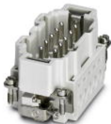
HEAVYCON Stifteinsatz, Serie B10, 10-polig, Schraubanschluss. PE-Anschluss mittels Zughülstechnik.
