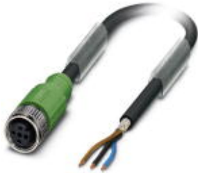
Sensor-/Aktor-Kabel, 3-polig, PUR halogenfrei, schwarzgrau RAL 7021, geschirmt, freies Leitungsende, auf Buchse gerade M12, A-kodiert, Kabellänge: 10 m
