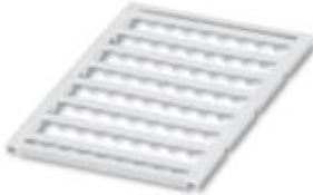
Marker für Klemmen, Matte, weiß, unbeschriftet, beschriftbar mit: BLUEMARK CLED, BLUEMARK LED, Plotter, Montageart: Stecken, für Klemmenbreite: 10 mm, Schriftfeldgröße: 3,97 x 9,45 mm
