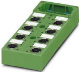
Sensor-/Aktor-Box-Grundgehäuse, Anschlussart: M12-SPEEDCON-Buchse Metall, Anzahl der Steckplätze: 8, Polzahl: 4, Steckplatzbelegung: einfach, Statusanzeige: Ja, pnp; Stammleitungsanschluss: Steckbarer Schraubanschluss, Schirmung: nein
