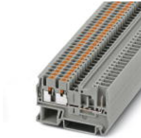
Durchgangsklemme, Anschlussart: Push-in / Steckanschluss, Querschnitt: 0,14 mm 2 - 4 mm 2 , AWG: 26 - 12, Breite: 5,2 mm, Höhe: 35,2 mm, Farbe: grau, Montageart: NS 35/7,5, NS 35/15
