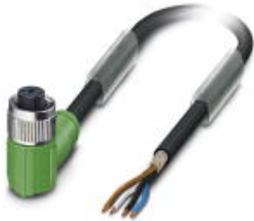
Sensor-/Aktor-Kabel, 4-polig, PUR halogenfrei, schwarzgrau RAL 7021, geschirmt, freies Leitungsende, auf Buchse gewinkelt M12, A-kodiert, Kabellänge: 1,5 m
