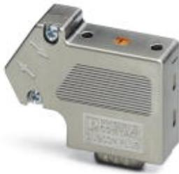
D-SUB-Stecker, 9-polige Buchse, zwei Kabelzuführungen unter 35° auf zwei Klemmreihen, Bussystem: CAN, CANopen, SafetyBus-P bis 1 MBit/s, Abschlusswiderstand über Schiebeschalter zuschaltbar, Pinbelegung: 2,3,7,9; Schraubanschlussklemmen
