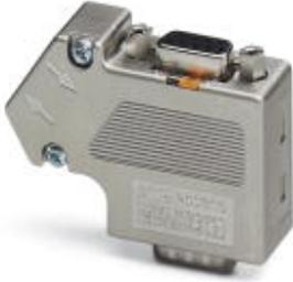
D-SUB-Stecker, 9-polige Buchse, Kabelzuführung unter 35°, Bussystem: CAN, CANopen®, SafetyBus-P bis 1 MBit/s, mit Pg D-SUB-Buchse zum Anschluss eines Programmiergeräts, Abschlusswiderstand ü. Schiebeshalter zuschaltbar, Pinbelegung: 2,3,6,7,9; Schraubklemmen
