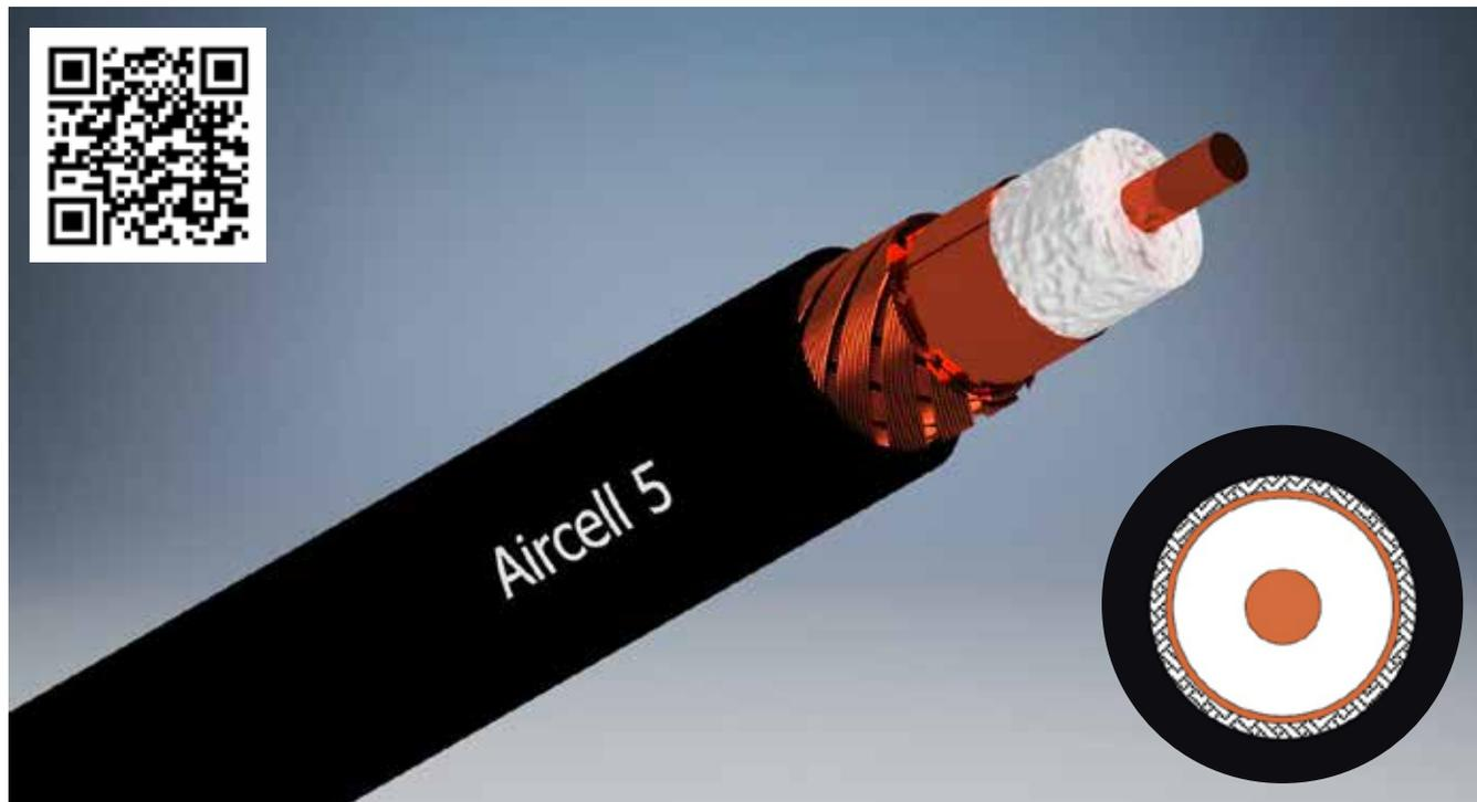
Aircell 5 ist ein fünf Millimeter dünnes, flexibles Koaxialkabel für den Frequenzbereich bis 10 GHz. Die im Verhältnis zum Durchmesser sehr niedrige Dämpfung und die alternative Verwendbarkeit von RG-58 Standard-Koaxialverbindern machen dieses Kabel nicht nur für Wireless-LAN, sondern für viele Anwendungen in der Nachrichtentechnik zur ersten Wahl.
