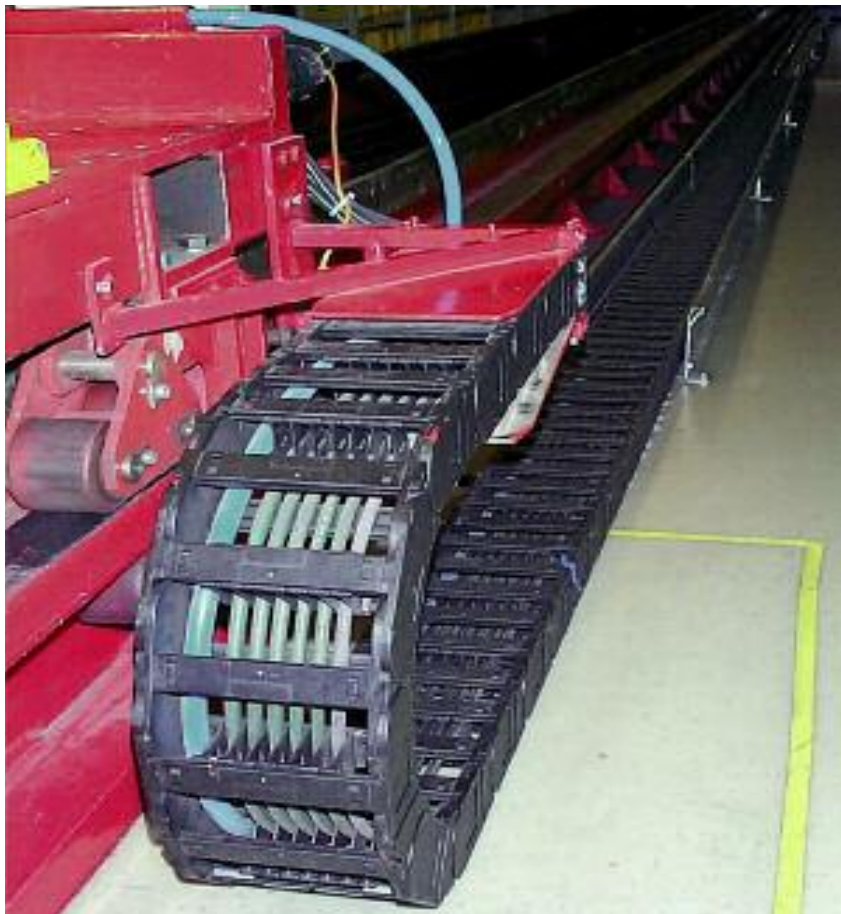
Chainflex® CF5/CF6 in Regalbediengerät: langer Verfahrensweg in Längsachse. E-Kette®: Serie E4/00 mit igus® Führungsrinne aus Stahl
