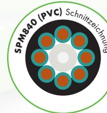
Um Knotenbildungen vorzubeugen, haben wir die 8-adrige Version **SPM840** (PVC) mit einem speziellen Füller und Soffflex-PVC-Mantel versehen.
