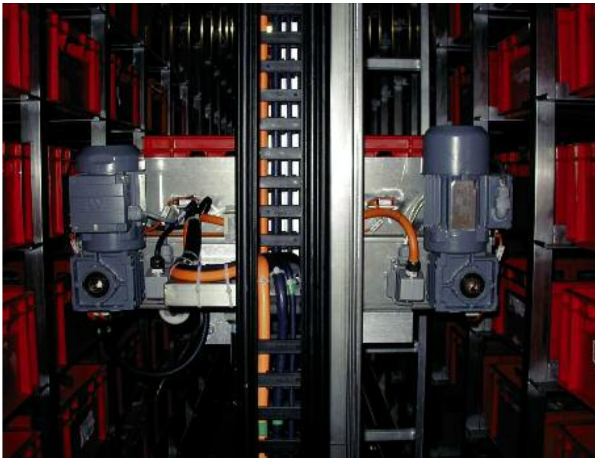
Steuerleitung Chainflex® CF10 in Regalbediengeräten. E-Kette®: System E2 Medium
