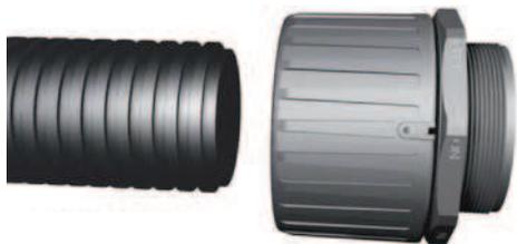
1. Achten Sie vor der Montage darauf, dass die Einkerbung des Verbindungsstcks auf die „On“-Position zeigt. Zum Befestigen der Verschraubungen drcken Sie das Schlauchende so weit wie mglich in die Verschraubung. Drehen Sie den Schlauch leicht, damit der Schlauch in die Verschraubung einrastet. Die Verschraubung ist sicher verriegelt.
