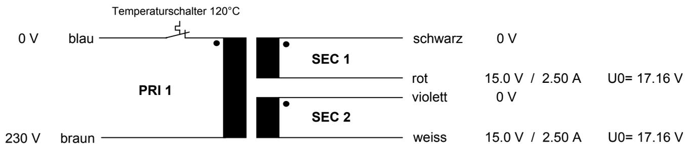
Verschaltungsmöglichkeiten: Parallelschaltung **15.0V / 5.00A** = schwarz mit violett und rot mit weiss verbinden
